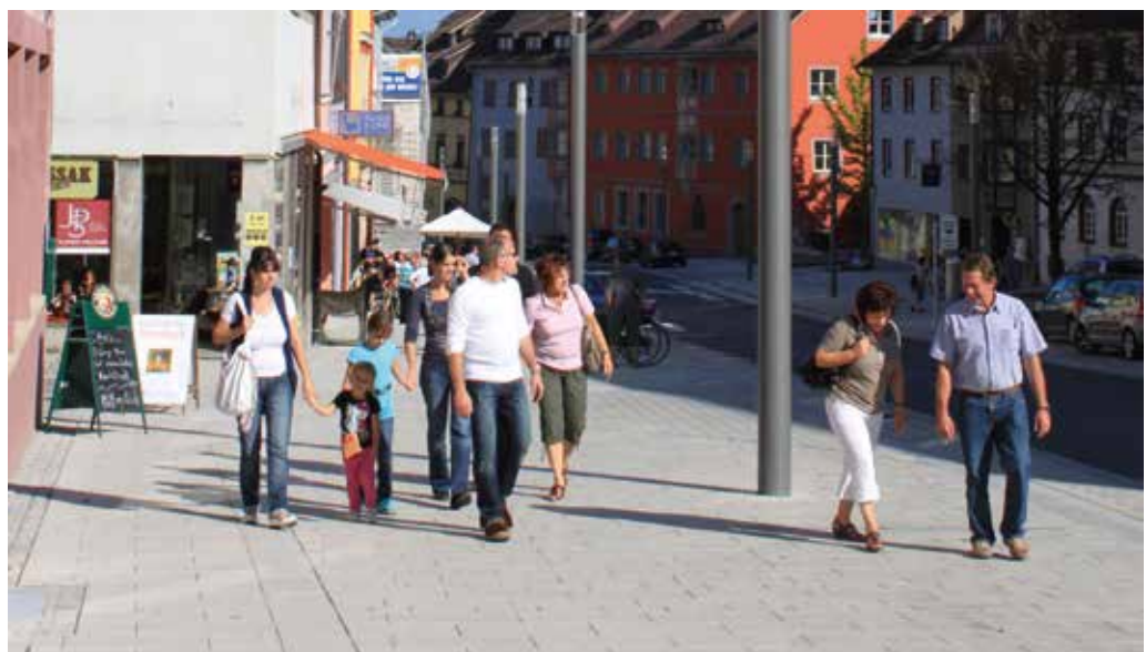
Barrierefreiheit dank abgesenkter Bordsteine und geeigneter Oberflächengestaltung in Rottweil
