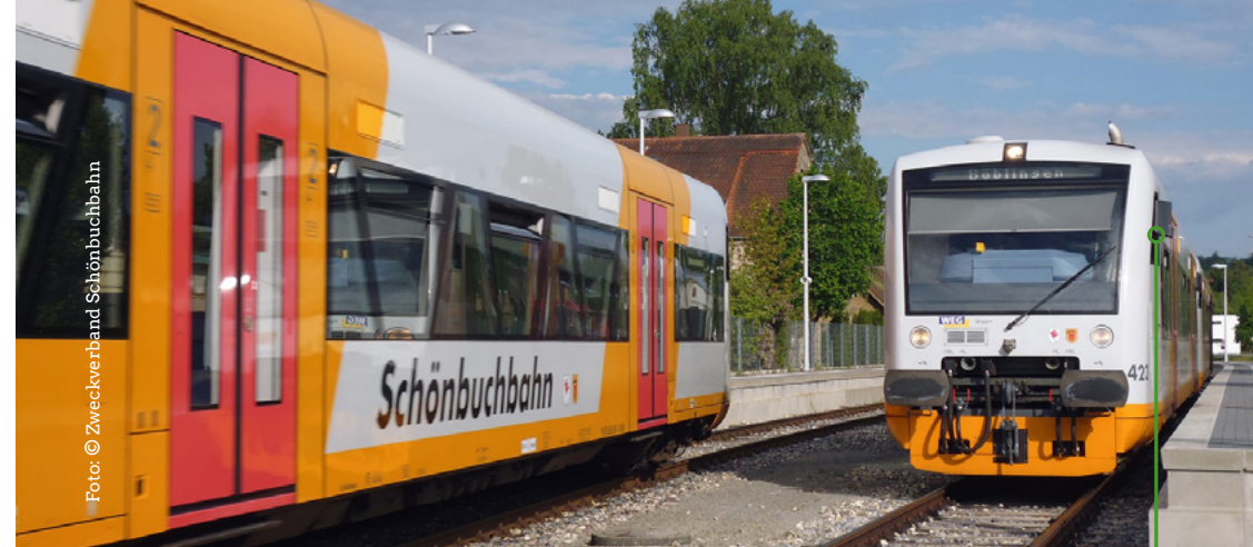
Ein neues, zweites Gleis ermöglicht den 15-Minuten-Takt auf der Schönbuchbahn.
